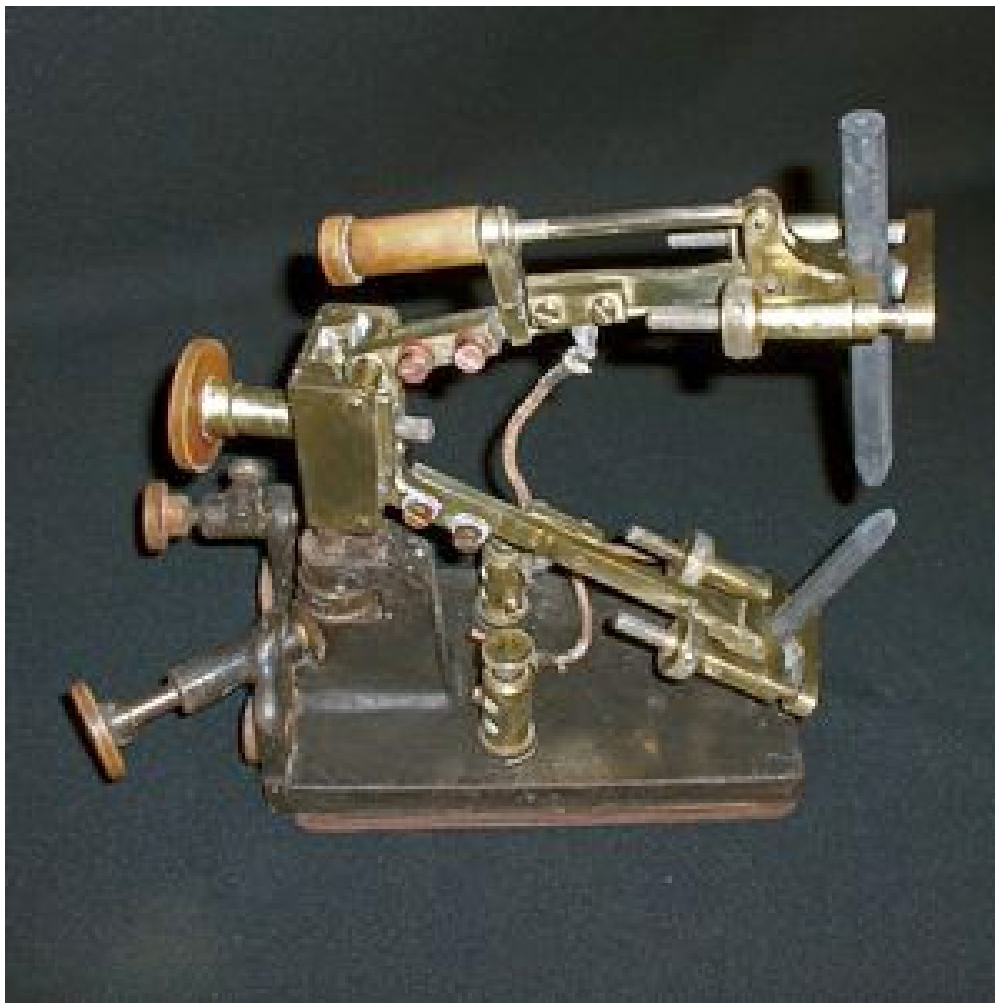
Figura 10. Equipamento para produzir arco voltaico, que possui dois bastões de grafite em que se aplica a alta diferença de potencial elétrico com a finalidade de ocorrer passagem forçada de elétrons, o que gera intensa luz [8].
