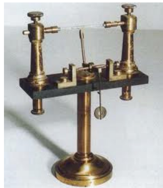
Figura 6. Coesor de Branly [5]: dispositivo que possui invólucro de vidro com limalhas de ferro que se alinham em presença de onda eletromagnética.
