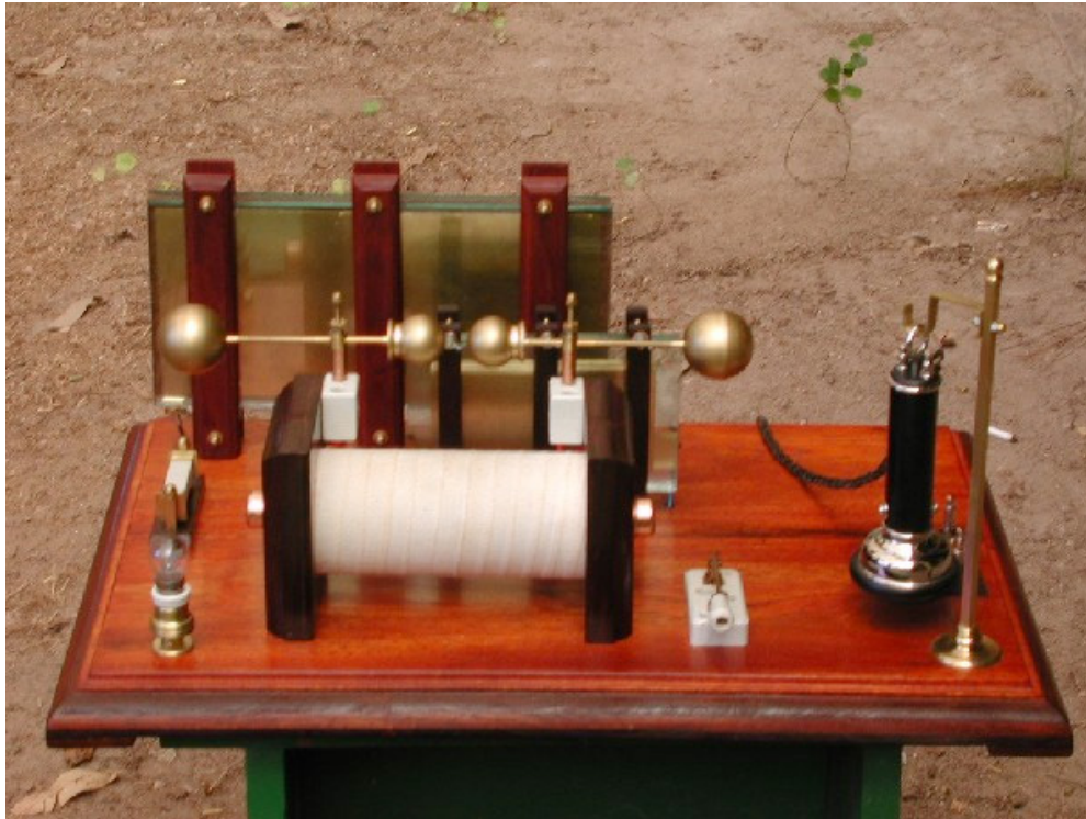
Figura 4. Bobina de Ruhmkorff [4]: transforma corrente contínua em corrente alternada de alta voltagem, através da construção adequada de enrolamentos primários, enrolamentos secundários e capacitores.
