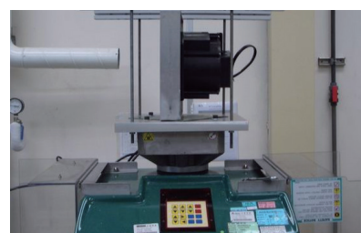
信賴性測試實驗室 機械衝擊等測試設備
