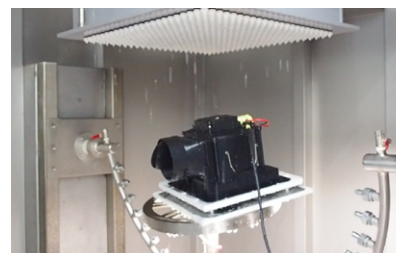
防水等級測試設備 防潮與灑水測試
